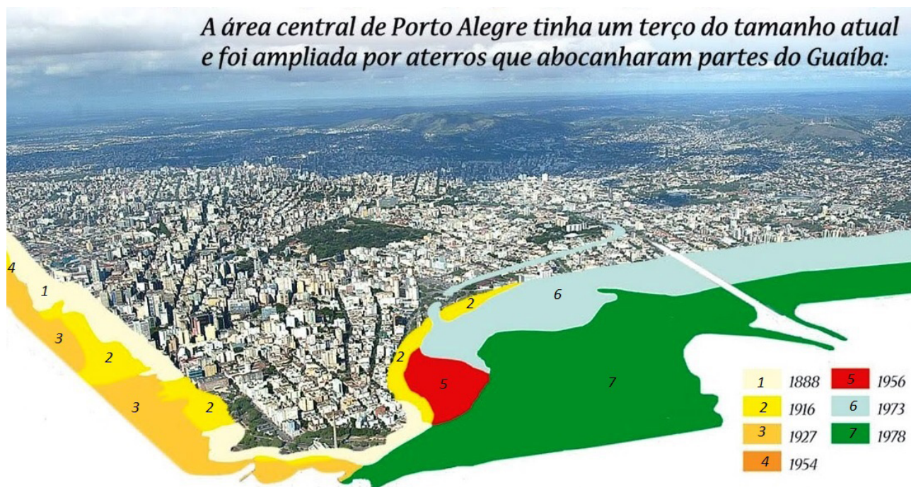
Figura 4 – Cronologia dos aterros na orla do Lago Guaíba durante o processo de urbanização de Porto Alegre.
